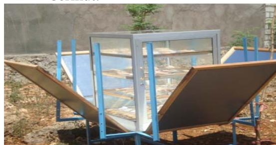
**Gambar 3.1. Pengering ikan dengan reflector cermin datar**
